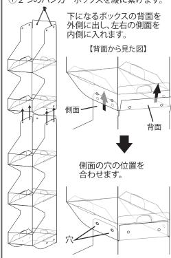
②付属の固定パーツで左右4ヵ所の穴を固定して完成です。
